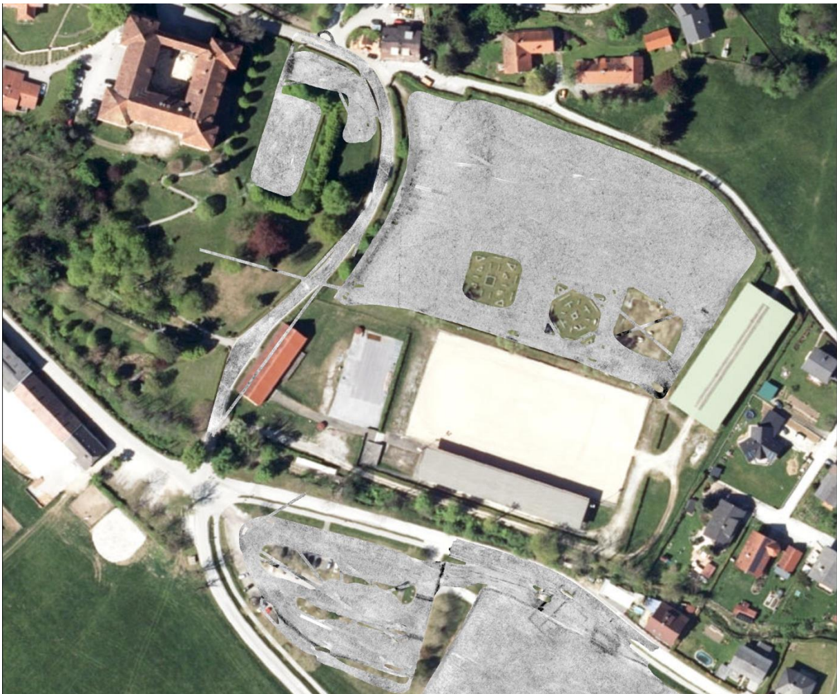
Tiefenscheibe oder Amplitudenflächenplan in Form einer Graustufendarstellung der Bodenradarmessungen im Bereich der Arena des Lipizzanergestüts Piber.
