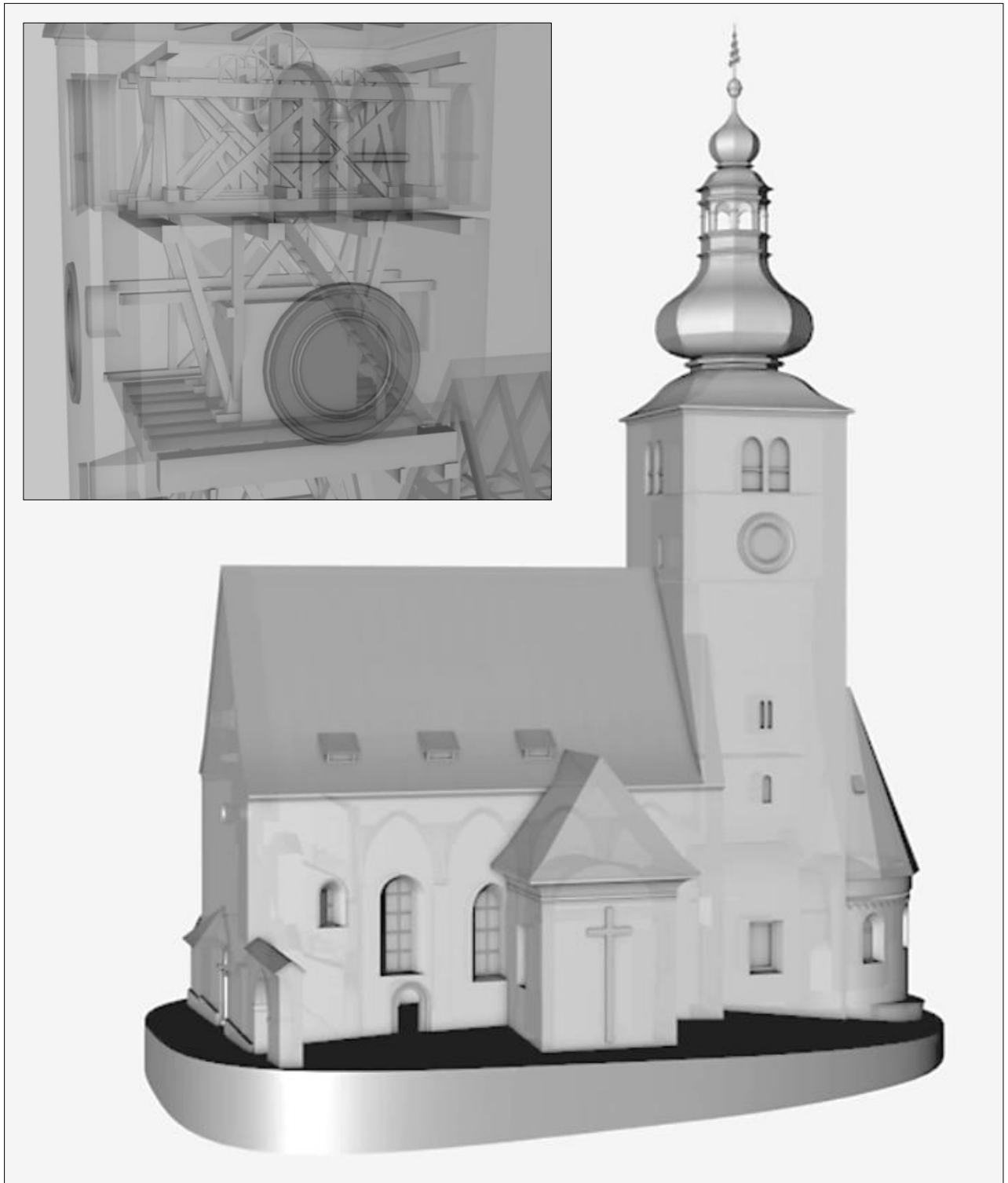
Gebäudemodellierung der Kirche St. Andreas in Piber. Aussenansicht und Innenansicht des Glockengestühls.
