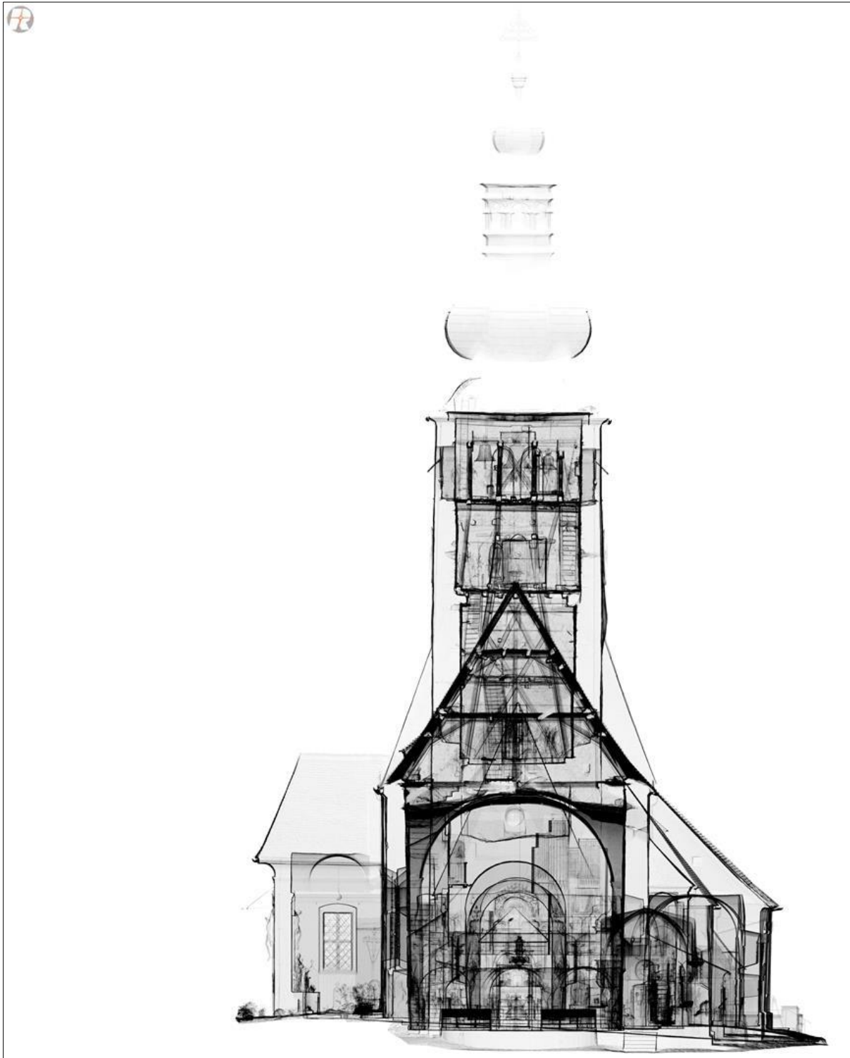
Querschnitt in Längsrichtung der Kirche St. Andreas in Piber erstellt aus der dreidimensionalen Punktwolke.
