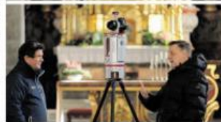
Sogar die Kirche wurde mit einem Laserscanner vermessen
